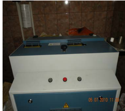
Masina Herzog HT 350 pentru polizat probe, Voltaj 3 x 400 V +/- 5%, Frecventa 50 Hz +/- 5%
