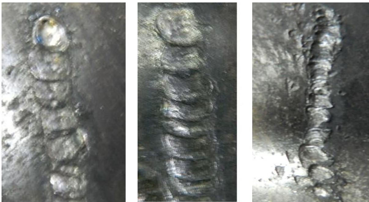
Fig. 3. Probele crăițuite cu electrodul fuzibil OK 21.03
