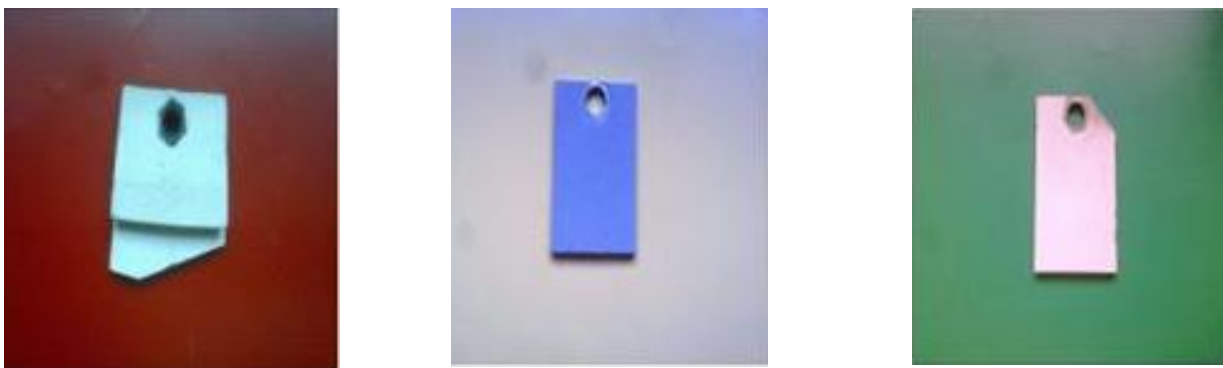
Fig. 1. Eșantion testat înainte (a și b) și după (c) șocul termic The tested specimen before (a and b) and after (c) thermal shock
