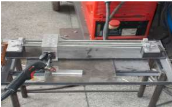
Fig. 3. Echipament crăițuire mecanizată Automatic torch guidance equipment
