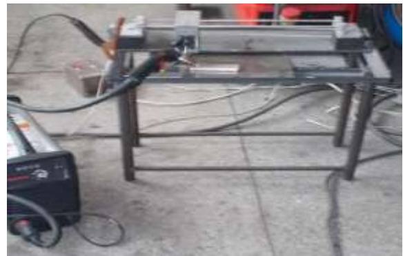
Fig. 3. Echipament crăițuire mecanizată Automatic torch guidance equipment
