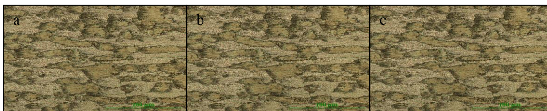
Fig. 7. Microstructura materialului de bază crăițuită cu: a) arc-aer, b) electrod învelit, c) plasmă manuală Microstructure of the basic material, gouged with: a) arc-air, b) coated electrode, c) manual plasma
