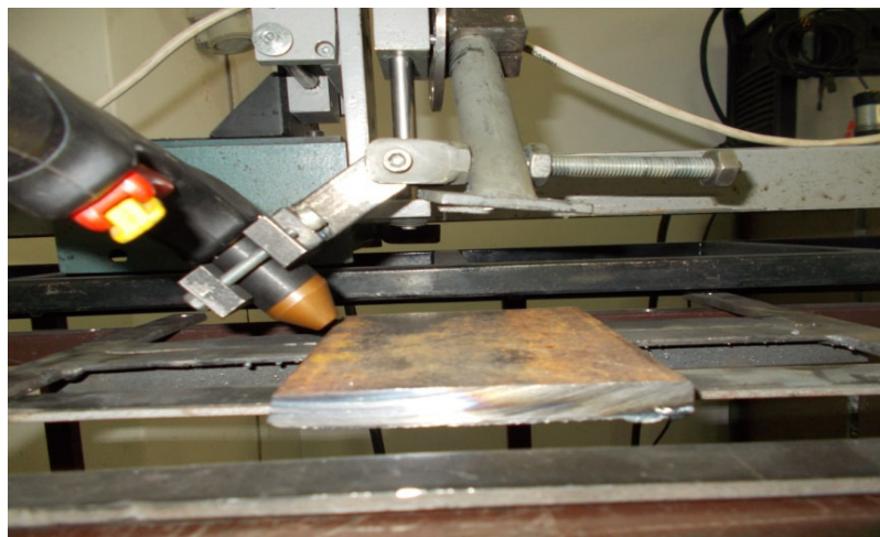
Fig. 2. Dispozitivul de avans liniar pentru tăiere / crăițuire Linear-advancement device for cutting / gouging
