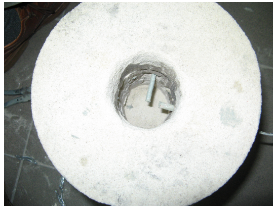
Fig. 8. Forma de turnare cu termocupluri Mould with thermocouples
